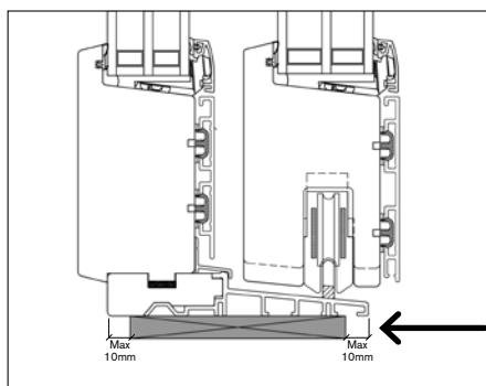
► Opklodsningen på bundkarmen skal sikre hele køreskinnes stabilitet, derfor skal opklodsningen dække bundkarmen, dog så 10mm på ydersiden/undersiden kan benyttes til fuge.
