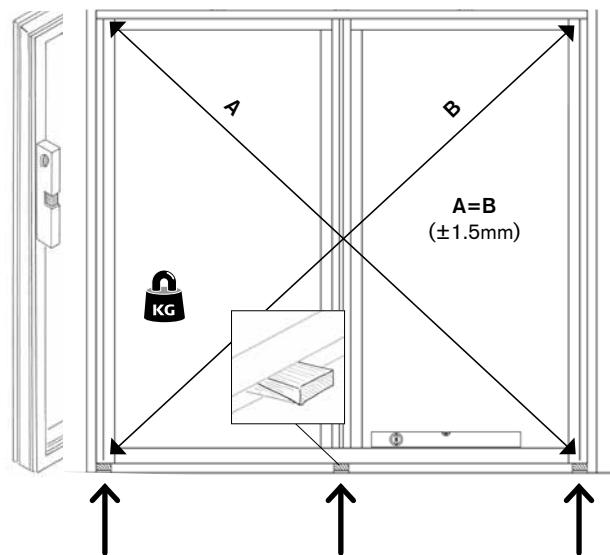
► **Montage.** Forbered 3 opklodsninger i murhullet - i vatter og i lige linje - én under hver sidekarm og én under posten. Løft så karmen over på de 3 forberedte opklodsninger.
